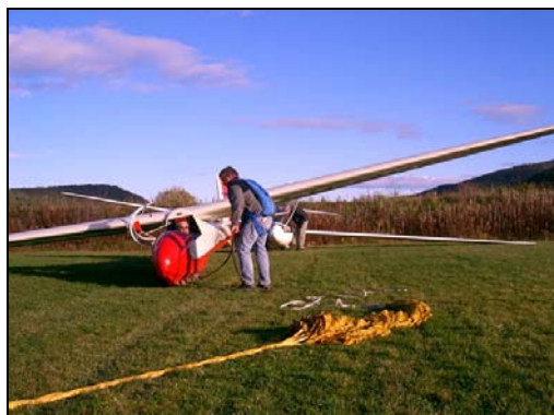
Jan Tore kobler til vinsj-wiren på Ka8 b
